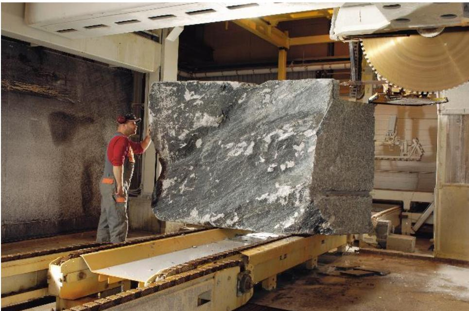
BU: Mit dem firmeneigenen Mammutti-Speckstein setzt der Feuerstätten-Hersteller auf ein einzigartiges Ofenmaterial. Die Ausrichtung der Talkschiefermaserung des Specksteins garantiert bei der fertigen Feuerstätte eine besonders lange, konstante und milde Wärmeabgabe.
